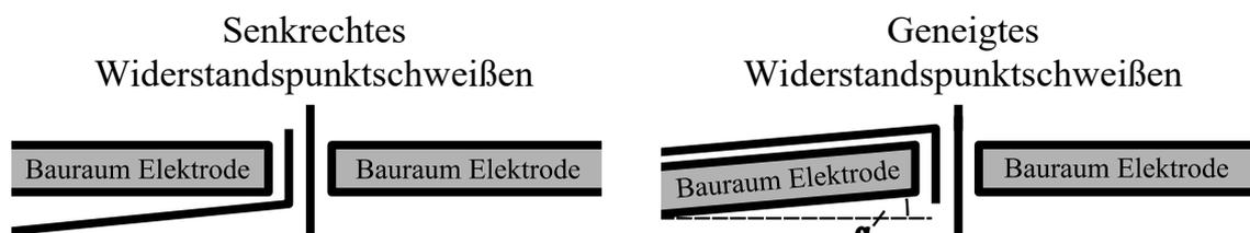
Abbildung 7-9: Senkrecht und geneigtes Widerstandspunktschweißen von Blechen
